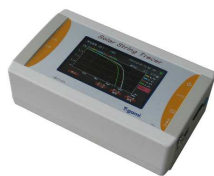
太陽電池パネルのストリング(系統)異常を検知
